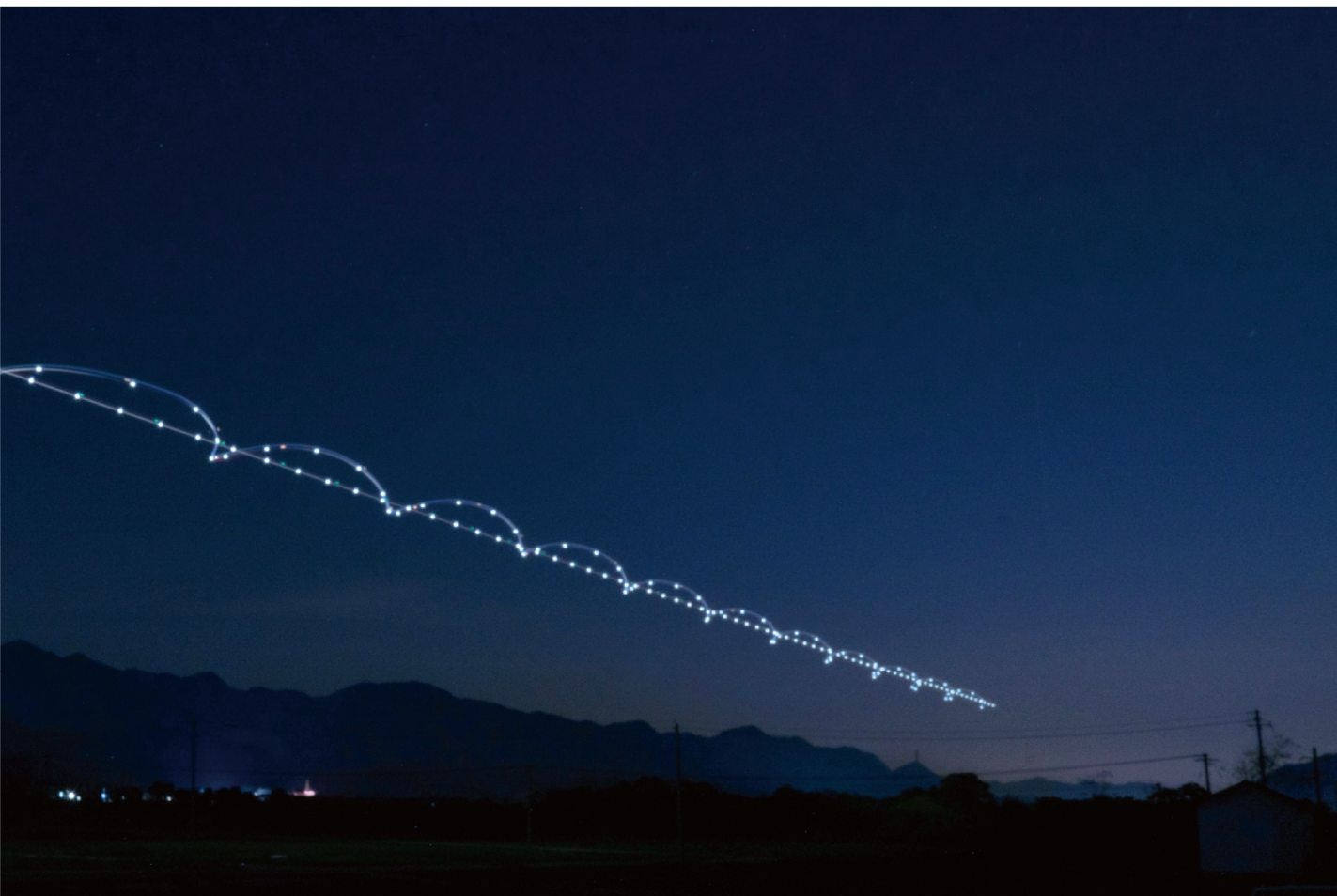
无人机追捕实验的轨迹图(长时间曝光摄影)
